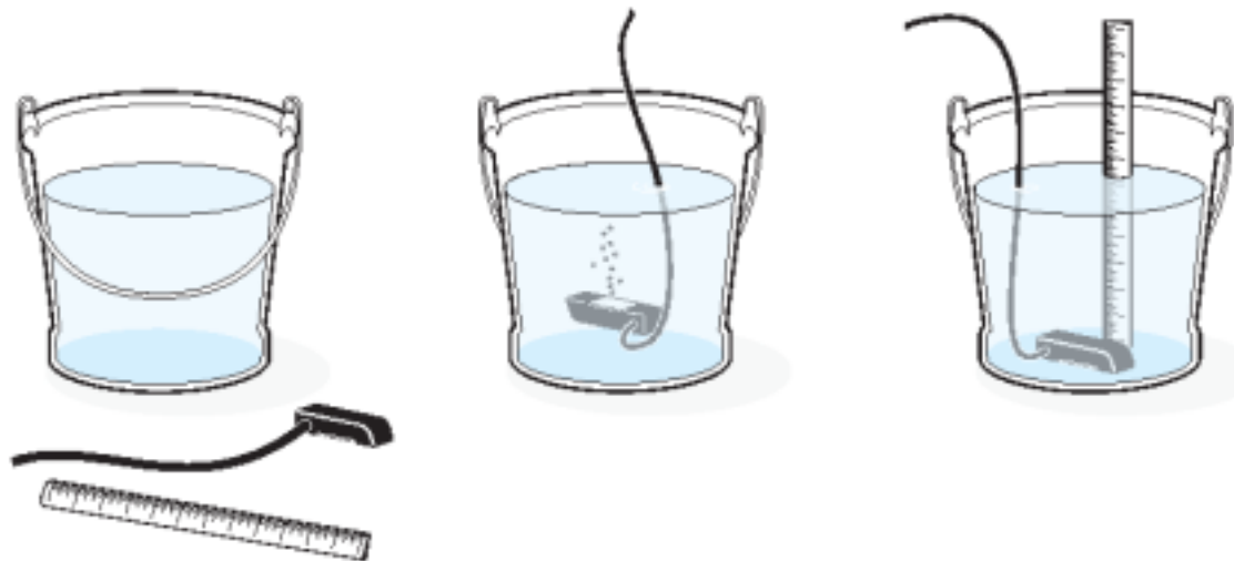
图 18 校准浸入式面积/速率传感器
